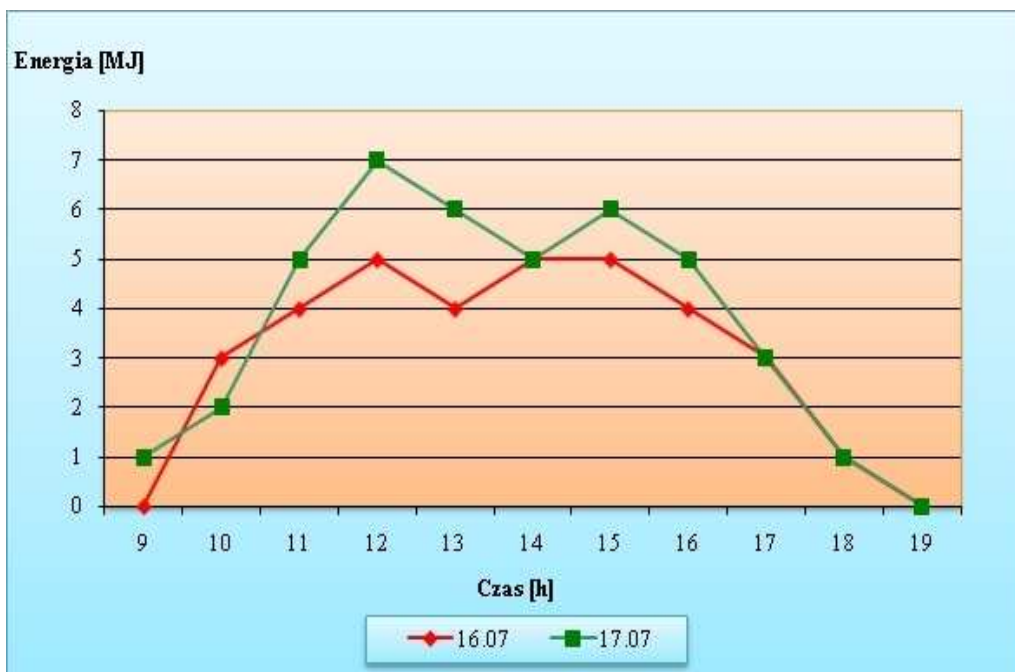
Rys.7. Energia w MJ uzyskana z instalacji solarnej w dniach 16 i 17 lipiec bieżącego roku
